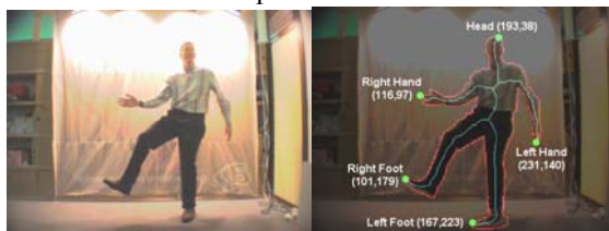
Figura 16: Ejemplo de análisis de la silueta humana y detección de los puntos críticos
