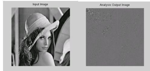
Figura 5: Ejemplo de descomposición de la imagen Lenna mediante wavelets morfológicos
