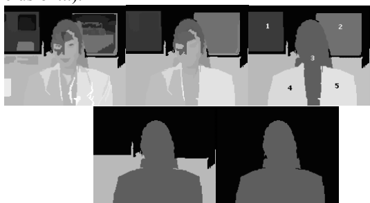
Figura 6: Análisis estructural mediante simetría, compacidad, regularidad e inclusión a partir de a) una partición inicial de 57 regiones que se estructuran progresivamente en, b) 24, c) 8, d) 3 y e) 2 regiones
